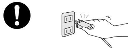
コードを引っばると、コードが破損し、感電・ショート・火災の原因となることがあります。
